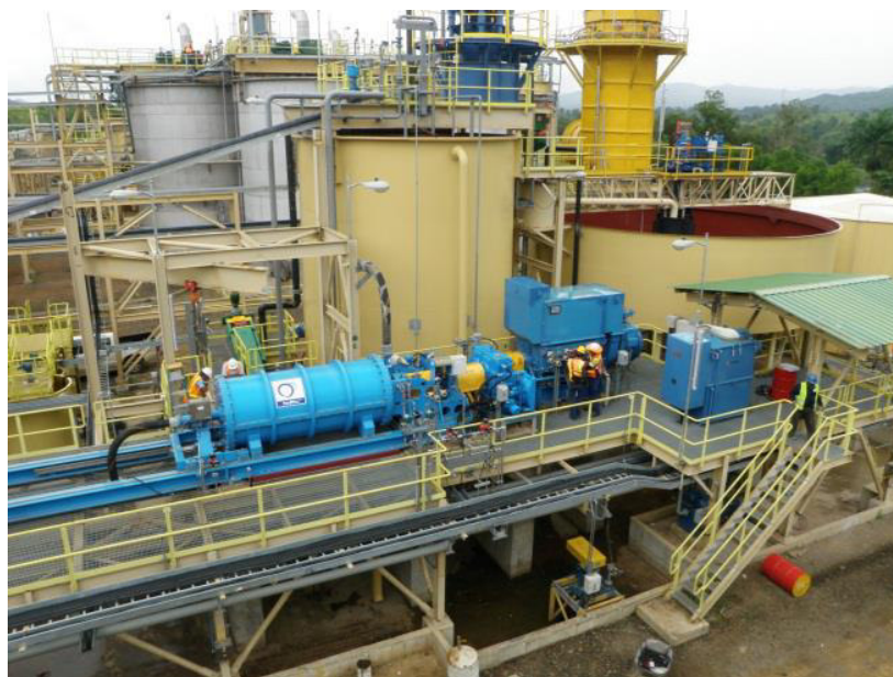
Рисунок 3.1 – Установка Albion в Las Lagunas Albion, для переработки золотосеребряного упорного концентрата
